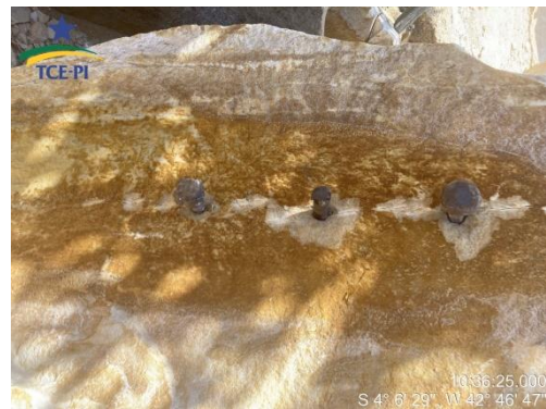
Figura 29 - "Pichotes" cravados, no sentido do plano de divisibilidade.
