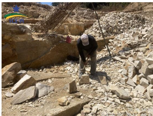
Figura 30 - Profissional usando o "marrão", a fim de chegar no tamanho padrão do paralelepípedo.
