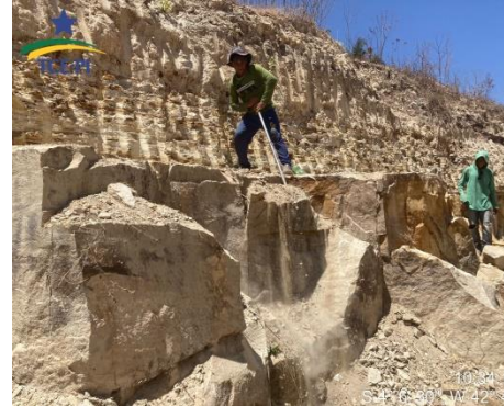
Figura 27 - Realização do tombamento do matacão para posterior divisão.
