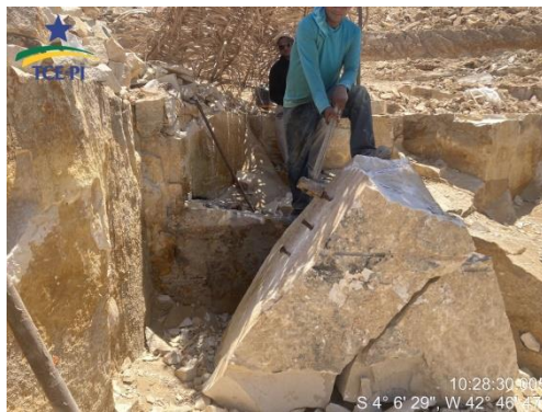
Figura 28 - Cravação dos "pichotes" para a formação das "folhas".
