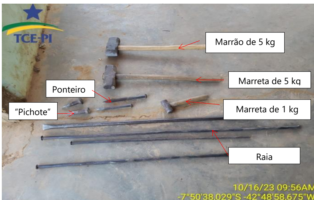
Figura 31 – Ferramentas utilizadas no serviço de desmonte manual de rocha arenítica.
