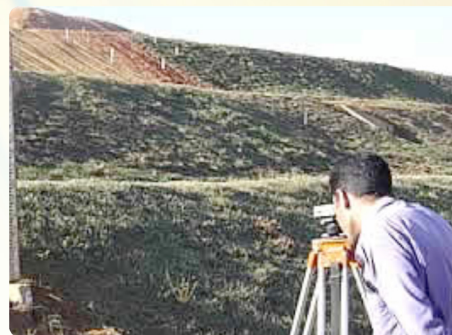
Acompanhamento da instabilidade de maciços após a finalização e a selagem de célula de resíduos sólidos.
